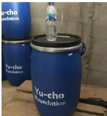
(写真1) 発酵槽を密閉し、嫌気発酵させている様子
